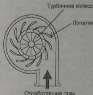
Высокие обороты двигателя (лопатки полностью открыты)
