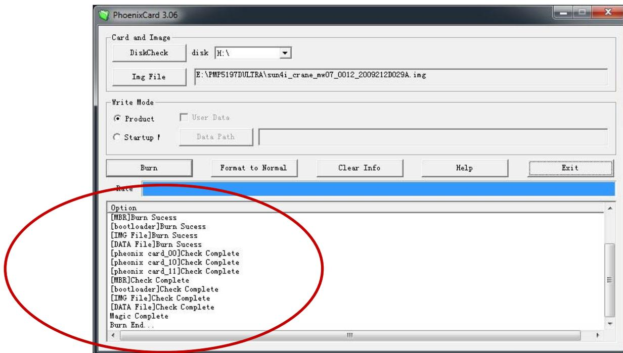
Теперь можно извлечь карту памяти из картридера. Вставляем карту памяти в устройство(планшет должен быть предварительно выключен полностью). Включаем устройство – появится красный прогресс бар, по окончании появится надпись об успешном обновлении. Извлекаем карту памяти и включаем планшет.
